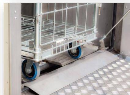
Le système de levage des guides permet de décharger les chariots sans avoir à entrer dans la cabine et facilite la sortie automatique des chariots.
