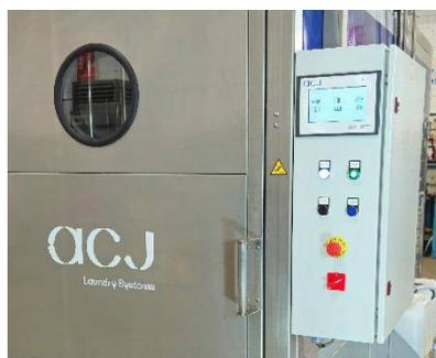
Tous les composants techniques sont situés à l'intérieur de la machine et sont accessibles à travers ses grandes portes. De plus, tous les composants se trouvent sur un côté de sorte que la machine peut être montée très près d'un mur sur un côté.
